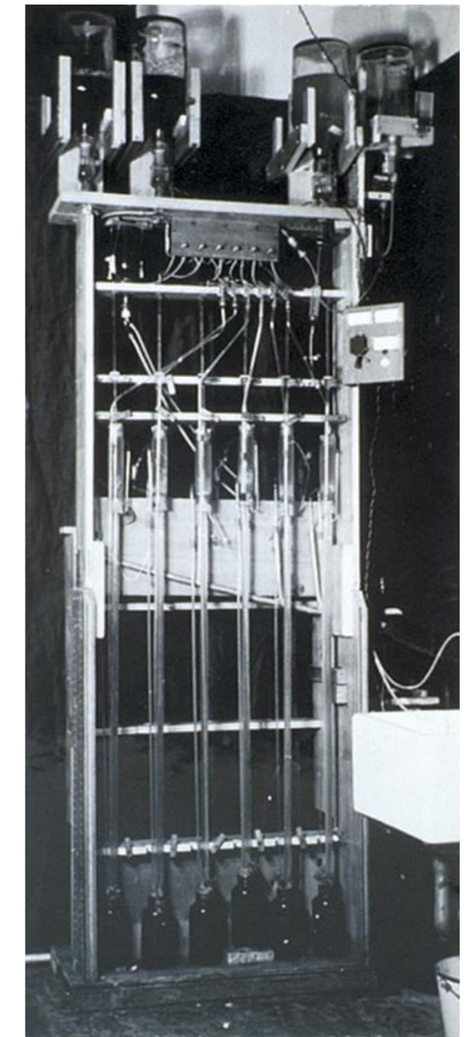
53. Aparelho concebido por Norman Heatley para a extração da penicilina
